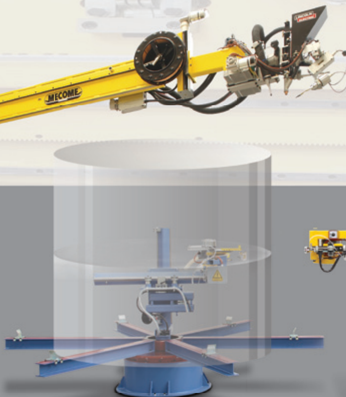
MBL 2x2 для TIG сварки с горизонтальным поворотным столом TRFO
