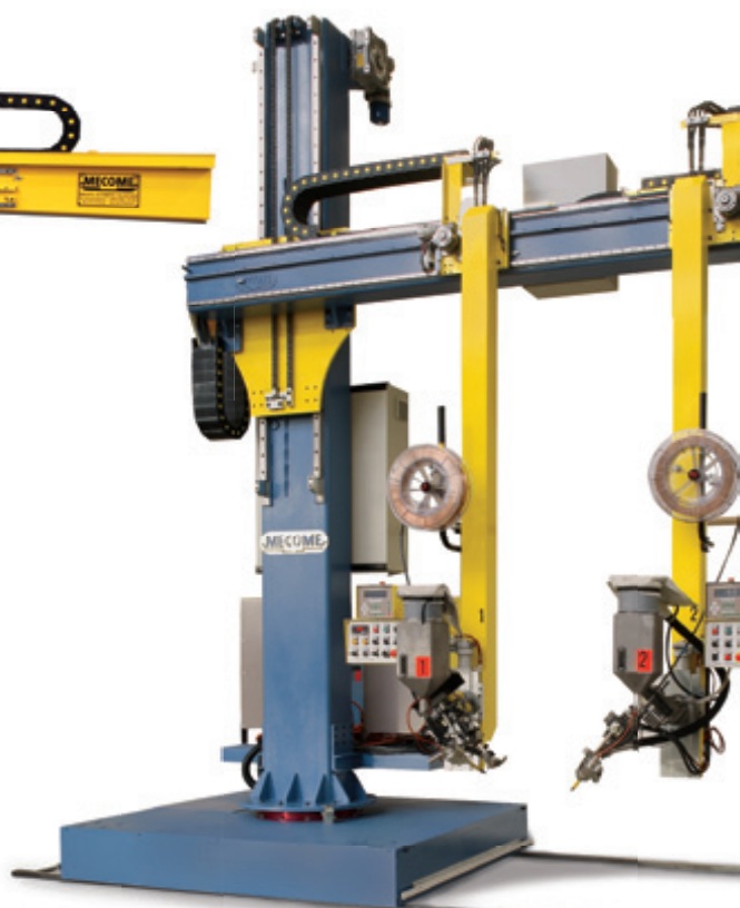
МABF 4x4 для сварки под слоем флюса, с системой поиска шва.
