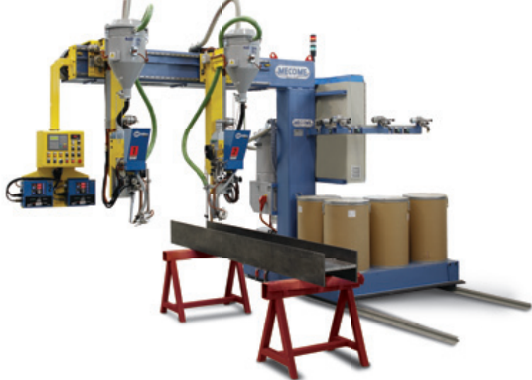
MABF 2x2 для сварки под флюсом двутавровых и корабчатых изделий
