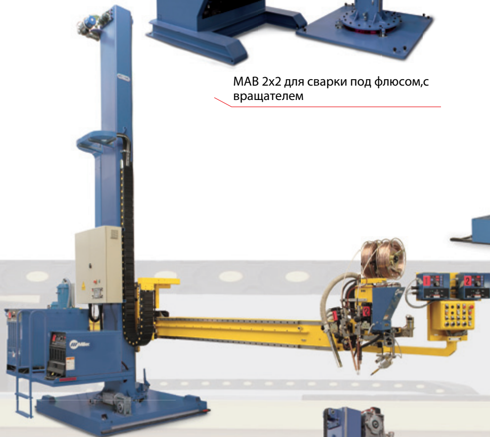
МAB 6x6 для сварки под слоем флюса, с тандемом, камерой и системой поиска шва.
