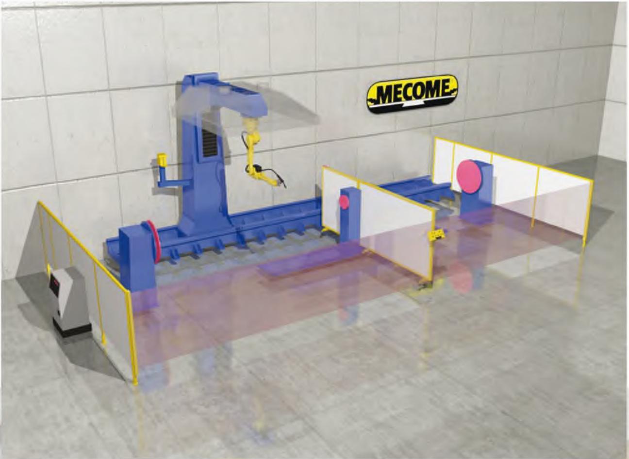
Isola con robot appeso e posizionatori orbitali paralleli alla via di corsa
