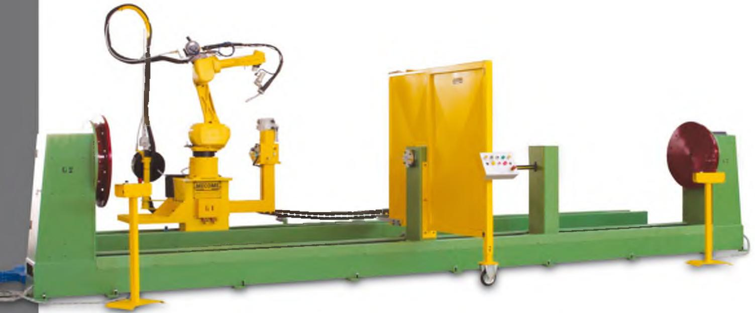
L'impianto è costituito da due posizionatori circolari (assi Alfa e Beta) posti in linea e paralleli al gruppo di traslazione del robot costituito da:
